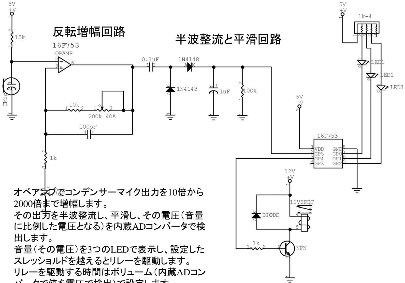
オペアンプでコンデンサーマイク出力を10倍から2000倍まで増幅します。
